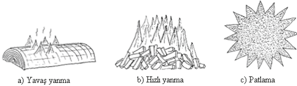
Şekil 1 - Yanma ve patlamanın şematik gösterimi
