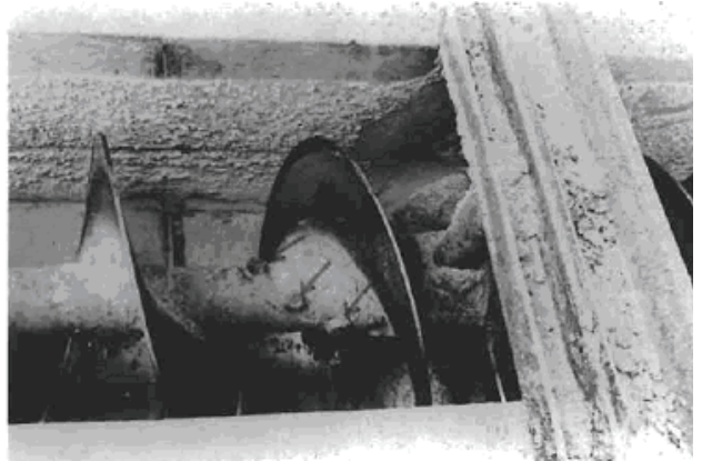
Şekil 6 - Vidalı konveyörün bıçaklarını şaft gövdesine tutturan vidalar
